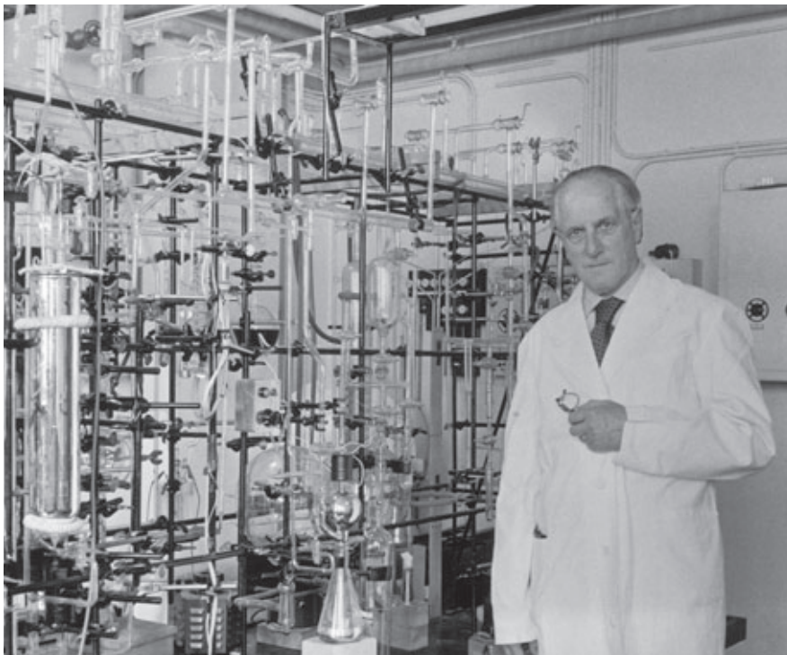
Abb. 11-17: Friedrich Paneth neben seiner Apparatur zur Mikroanalyse von Edelgasen, um 1956.
